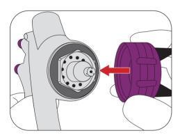
**3** Reassemble the air cap.
